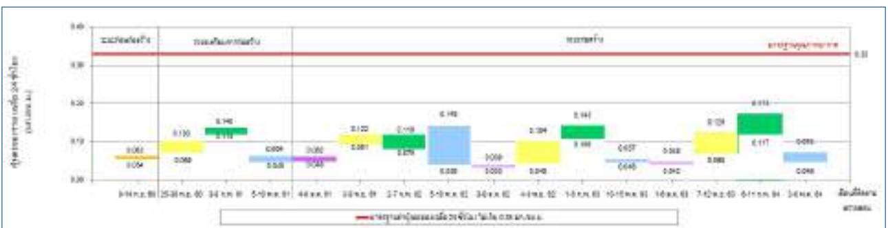
ภาพผลการติดตามตรวจสอบปริมาณฝุ่นละอองรวม เฉลี่ย 24 ชั่วโมง บริเวณใกล้เคียงพื้นที่ก่อสร้าง
